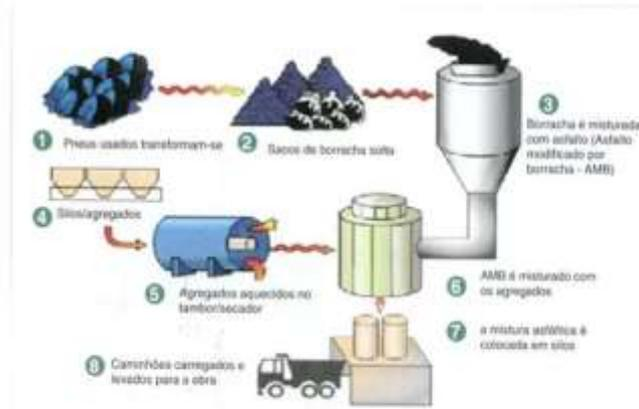
FIGURA 3- Processo de obtenção do Asfalto-Borracha
