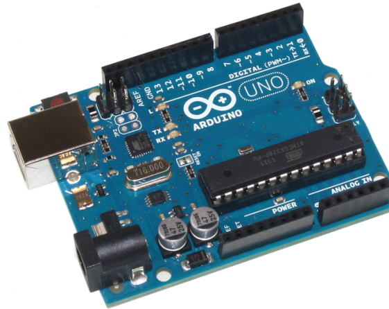
Figura 2.1: Placa do Arduino Uno. Fonte: https://www.robocore.net
