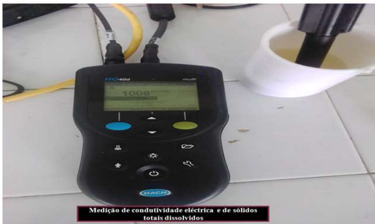
Figura1: A: Ilustração das análises na determinação de Condutividade eléctrica e sólidos totais dissolvidos.
