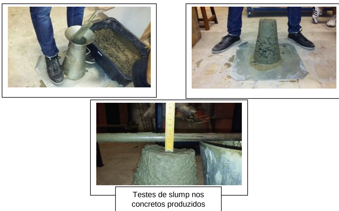
Figura 5 – Testes de slump Fonte: Lucas da Silva et al, 2017.
