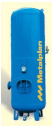
Um reservatório deve sempre atender a PMTA (Pressão Máxima de Trabalho Admissível) do sistema, ser projetado, fabricado e testado conforme um conjunto de normas nacionais e internacionais (NR-13, ASME, etc.), possuir os acessórios mínimos (manômetro e válvula de segurança) obrigatórios instalados e receber uma proteção anti-corrosiva interna e externa de acordo com sua exposição à oxidação.
