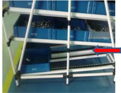
Figura 16: rampa de retorno das caixas *kanban* vazias
