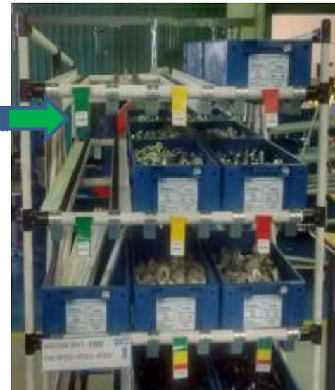
Figura 15: retirada das caixas *kanban* – iniciar pela faixa verde
