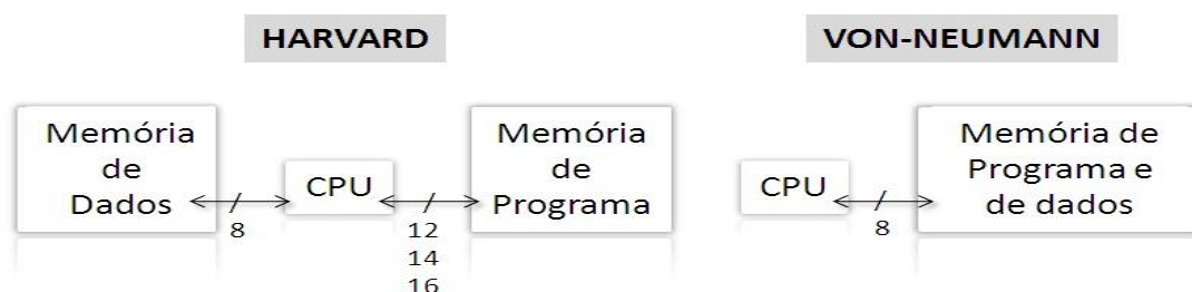
Figura 2.17- Arquitetura Harvard x Arquitetura Von-Neumann [15]
