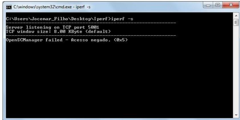
Figura 6: Visualização da ferramenta Iperf em linha de comando.
