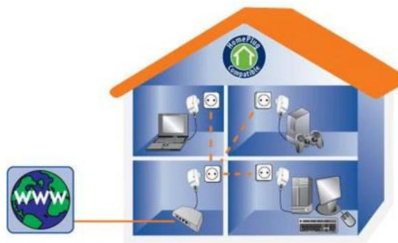
Figura 4 – Ilustração de uma casa com PLC.
