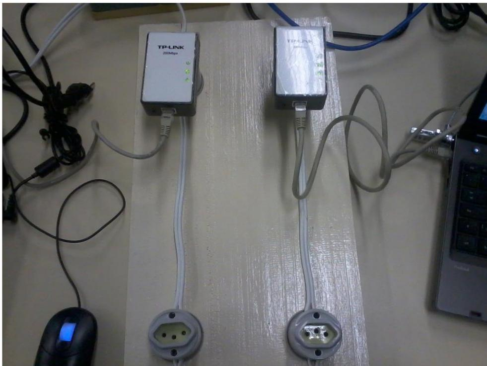
Figura 8: Adaptadores PLC na rede elétrica
