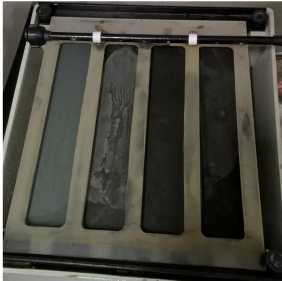
Figura 2 - Lixadeira manual com várias granulometrias
