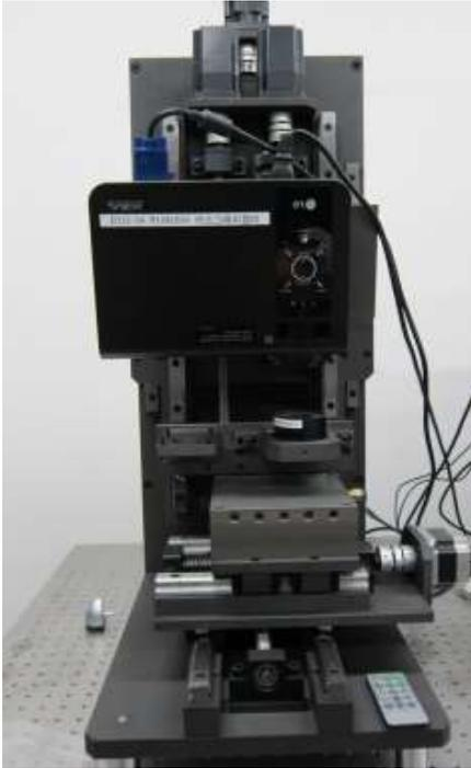
Imagem LPR 1.1.1. C2014 - Modelo de equipamento de litografia simples, de mesa para pequenas aplicações e pesquisa e estudo laboratorial. O modelo, a marca e fabricante não serão divulgados por haver vários no mercado internacional, facilmente encontrado.
