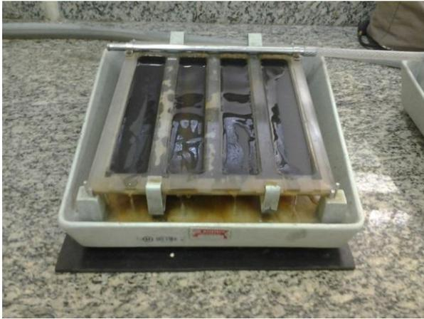
**Figura 5.** Lixadeira Manual Metalográfica utilizada no processo de lixamento
