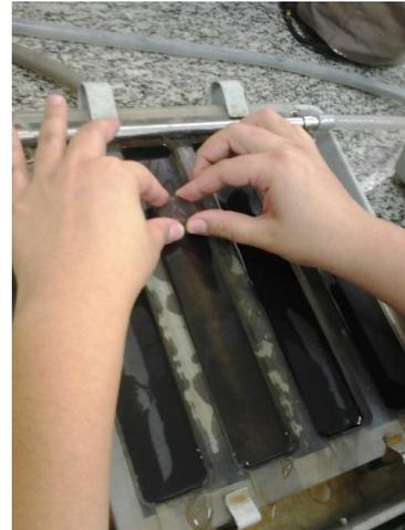
**Figura 6.** Amostra de um dos compósitos a base de cobre sendo lixada
