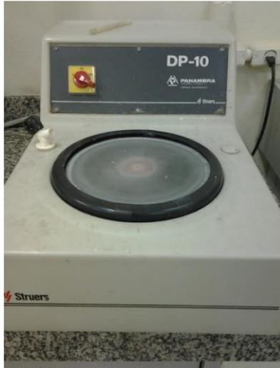
**Figura 8.** Politriz Automática utilizada para o polimento final das amostras
