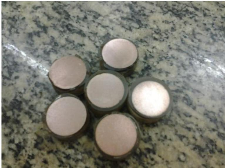
**Figura 7.** Amostras de compósitos a base de cobre após o processo de lixamento metalográfico
