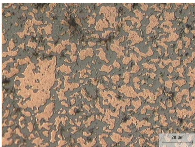
**Figura 15.** Micrografia óptica de amostra do composto 85% Cu – 5% Cr – 5% Ag – 5% Al<sub>2</sub>O<sub>3</sub> compactada a frio e sinterizada (923K por 21.600s). Observa-se coalescimento mais intenso das partículas de cobre, porosidade relativa, pequena aglomeração de partículas mais finas de alumina bem como formação de terceira fase a ser identificada por microanálise
