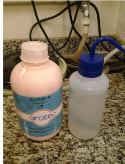
**Figura 9.** Pasta para polimento metalográfico à base de alumina e água como lubrificante
