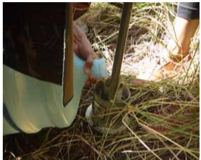
Figura 10: Derram. água no infiltrômetro de duplo cilindro
