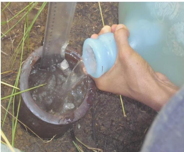
Figura 9: Derram. água no Infiltrômetro de Hills
