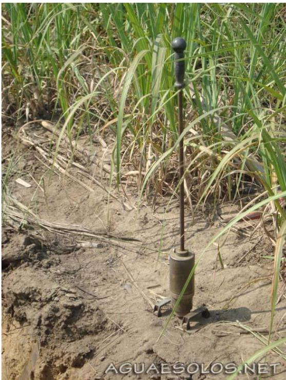
*Fig. 11: Exemplo de penetrômetro de impacto*
