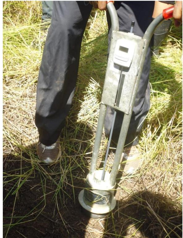
Figura 8: Infiltrômetro de duplo cilindro
