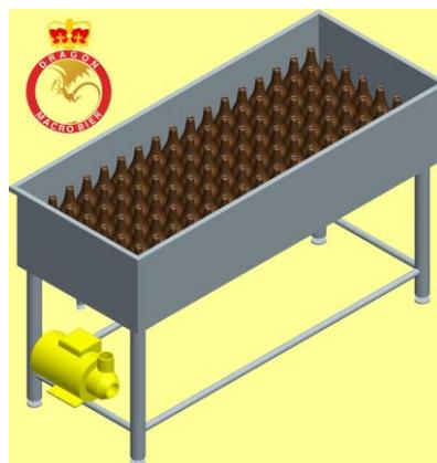
**Figura 4:** Pasteurizador Retangular
