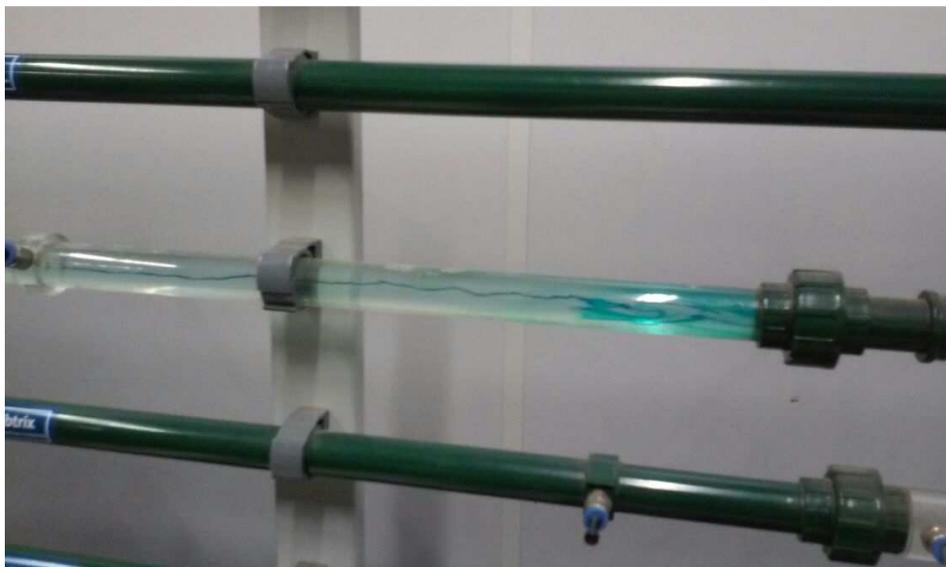
Figura 2 - Uso de corante para verificação do regime do escoamento no tubo.
