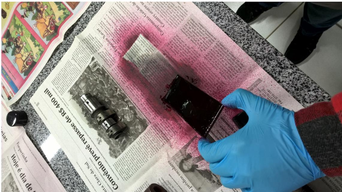
Figura 1 – Aplicação do Líquido Penetrante
