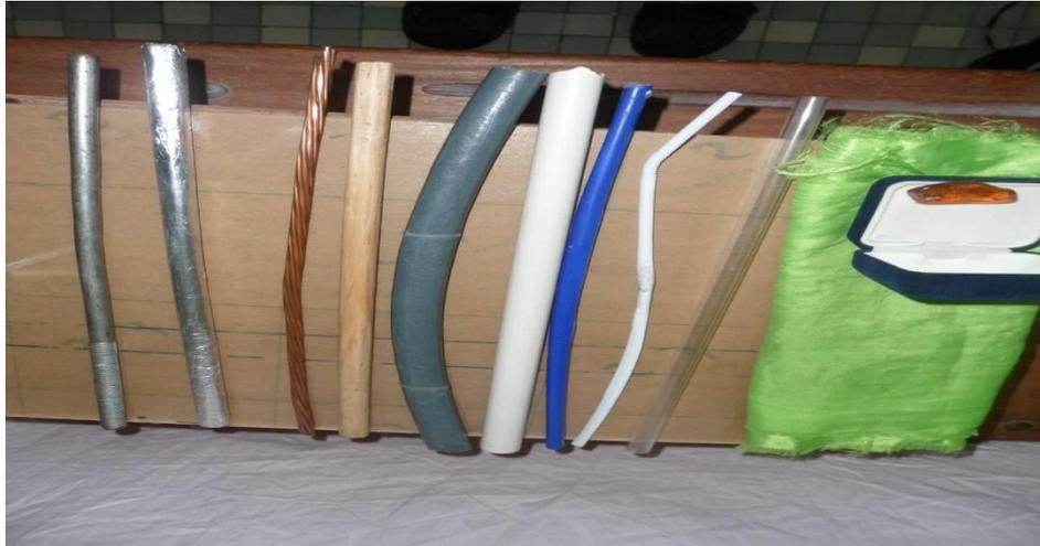
Ilustração 4.16: Material usado para o teste de condutores e isoladores
