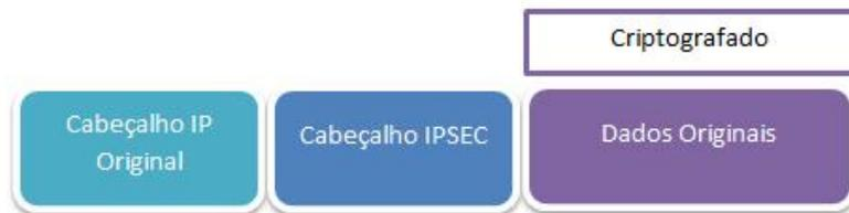
**Figura 4.** Estrutura do Pacote IPSec – Modo Transporte
