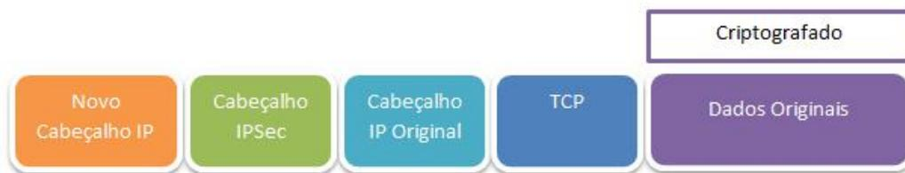
**Figura 5.** Estrutura do Pacote IPSec – Modo Túnel
