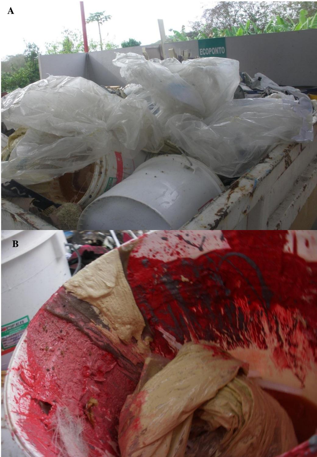
**Figura 3:** Problemas enfrentados na Gestão Ambiental da empresa Pifer Railway Interiors. **A** - Resíduos Recicláveis sendo descartados junto aos Resíduos Perigosos; **B** - Desperdício de matérias-primas (gel, resina e talco, principalmente), contribuindo para o aumento da geração de resíduos. (Fonte: a autora).
