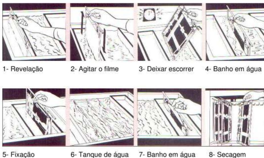
Figura 5- Processadora manual
