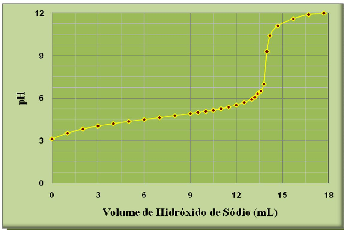
Fig. 1 - pH da solução de vinagre de vinho em função do volume de NaOH.
