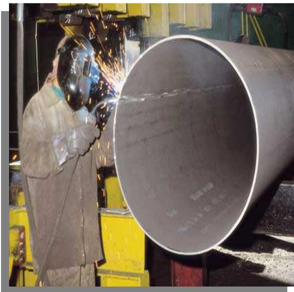
Figura 18 – Tubo com solda longitudinal
