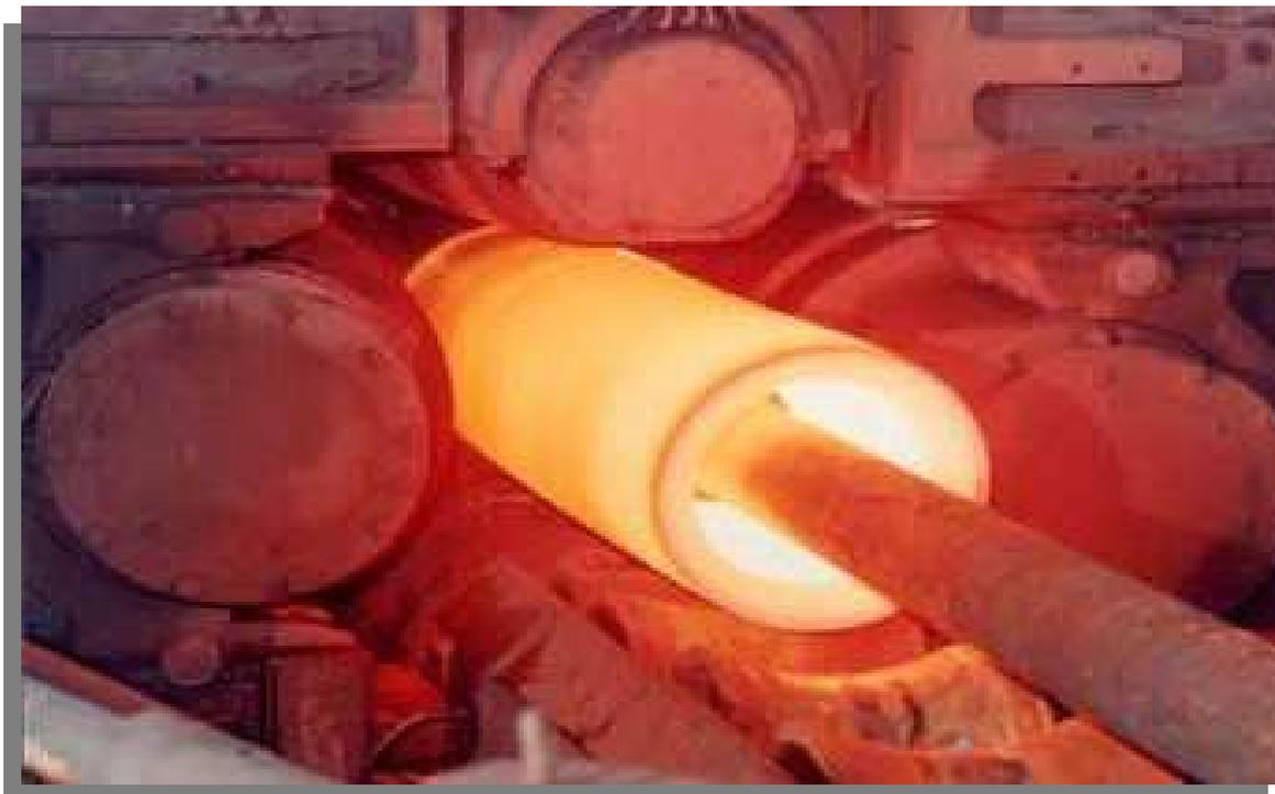
Figura 16 – Paredes espessas do tubo que está em processo de formação
