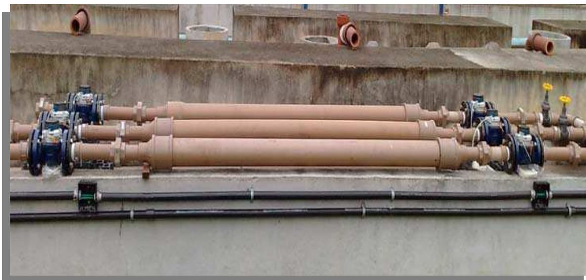
Figura 48 – Tubulações em PVC para utilização na avaliação de perdas físicas de água em rede de distribuição
