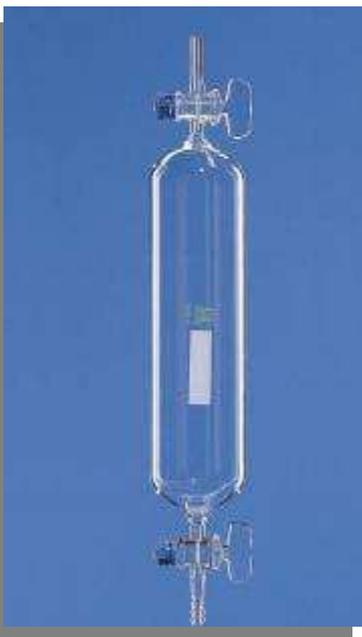
Figura 27 – Tubos para a condução de gases
