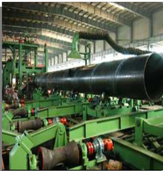
Figura 29 – Tubo com solda helicoidal
