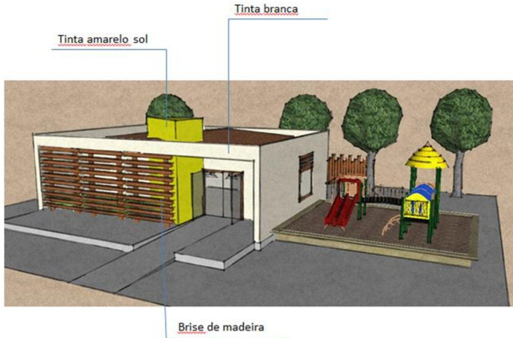
**Ilustração 15: Volumetria da creche com esquema preliminar de materiais. Apesar de não ter a mesma linha "rural" das outras edificações, a edificação foi pensada com materiais de fácil acesso no mercado. O Brise de madeira por exemplo, pode ser facilmente executado manualmente.**
