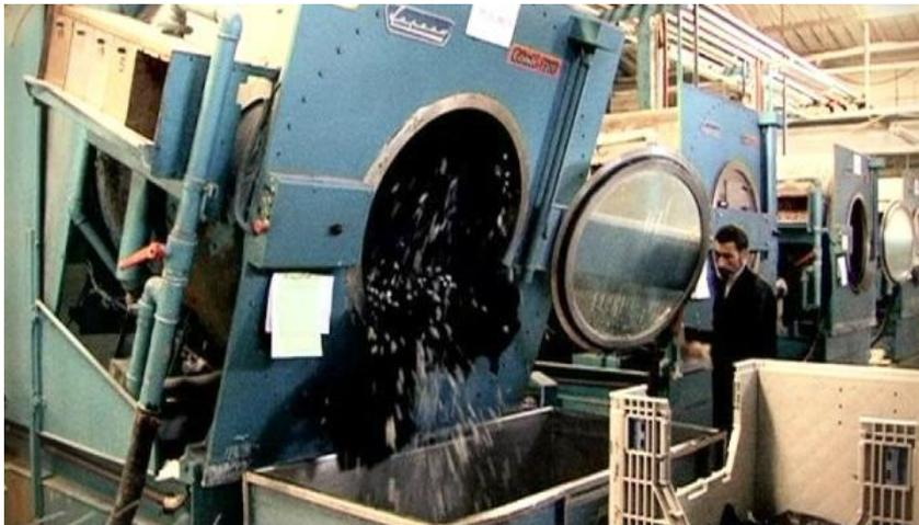
*Fig. 6 – Máquina Industrial utilizada no processo de lavagem*
